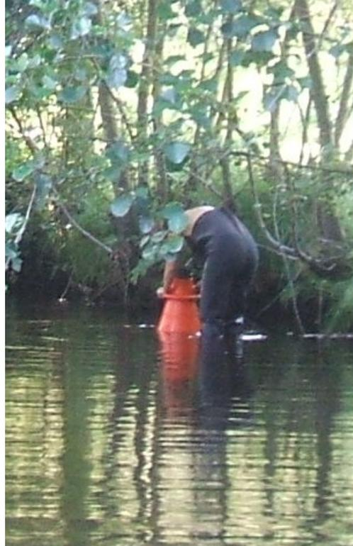
**Figura 2.1.** Mirafondos o batiscopio. Muestreo con el mirafondos.
