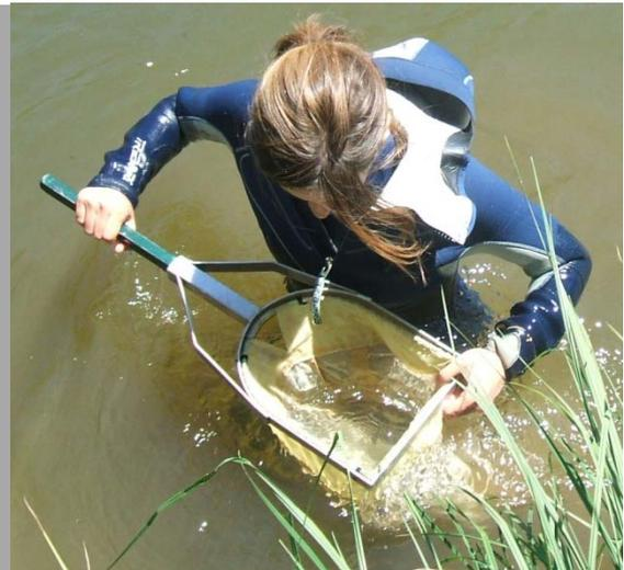
**Figura 2.2.** Manga indeformable para excavar y filtrar la arena y sedimentos finos.
